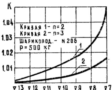
Рис.14.График зависимости относительной площади контакта К от шероховатости поверхности сжимаемых тел при большой нагрузке.
